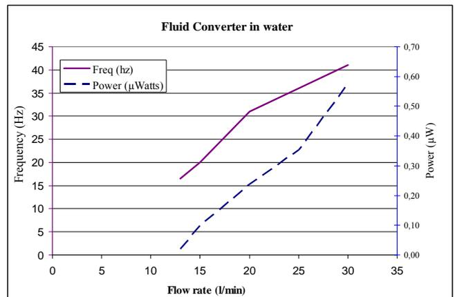
Figure 7: Frequency and power output over different flow rates for the prototype model in **Fehler! Verweisquelle konnte nicht gefunden werden.**
